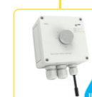
TEV-3 Termostat pentru reglarea încălzirii (răcirii), cu domeniu reglabil 5..+35 °C, senzor extern NTC. Contacte de ieșire 16 A contact comutator potențiomtric și indicare pe panou.
