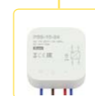
PSB-10-24 Intrare: AC 110-250 V Ieșire: DC 24 V stabilizat Sarcină: 0.42 A/10 W - separate galvanic - siguranță electronică - protecție termică - MINI, într-o cutie (cum ar fi KU-68). pagina 69
