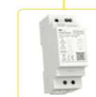
PS2M-30/24V Intrare: AC 100 - 240 V Ieșire: DC 24 V stabilizat Sarcină: 1.25 A/30 W. pagina 70
