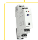
TER-7 Monitorizarea încălzirii motoarelor în intervalele date de rezistivitatea senzorului încorporat PTC(1.8-3.3 kΩ), funcții adiționale (memory, reset), Contacte de ieșire 2x 8 A contact comutator, alimentare: AC/DC 24-240 V.
