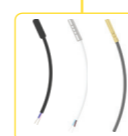
TC, TZ, Pt100 - senzori externi de temperatură pentru termostate, cu lungimi de 3 m, 6 m, 12 m - TC/TZ: senzor ntc 12 kΩ/25 °C - Pt: element Pt100 (numai pentru TER-3G).
