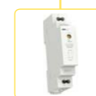
PS1M-15/24V Intrare: AC 100 - 240 V Ieșire: DC 24 V stabilizat Sarcină: 0.625 A/15 W. pagina 70
